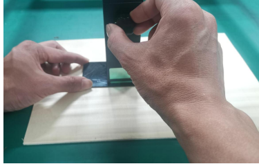
Regolazione della distanza del laser
