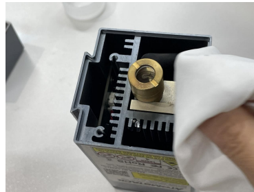
Nettoyer avec de l'alcool et un chiffon sans poussière
