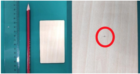
Image 1 dessiner un point central sur l'objet gravé
