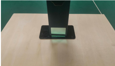
Placer la plaque de mise au point
